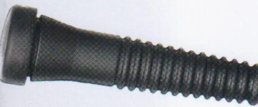
Yuvarlak şekilli, uzun yolma bölgelerine sahip düş üstü yuvarlak dış araları açık yolma parmağıdır.İnce yapısı sebebiyle orta sert ve sert hamur karışımı uygulanır.Sert karışımından yapılan parmaklar genellikle hindi yolma makinelerinde kullanılır.
