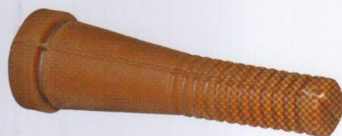
Oval şekli diş üstünün köşeli olması nedeniyle. Aşırı yumuşak hamur kullanıldığı için özellikle kısa yolma hatlarında, tavuçun derisine zarar vermeden mükemmel tüy uzaklaştırılması sağlanır. Stork Meyn Systemate marka yolma makinelerinde kullanılabilir.
